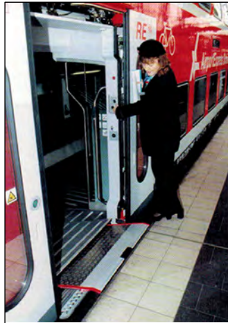
Abbildung 2-4: Überfahrrampe für Rollstühle bei einem Doppelstockwagen JANICKI/REINHARD, 2013, S. 482.
