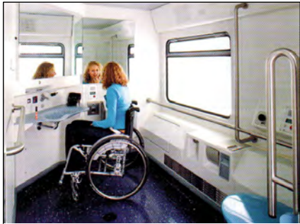
Abbildung 2-5: Behindertengerechtes WC im Doppelstock-Steuerwagen (JANICKI/REINHARD, 2013, S. 456).
